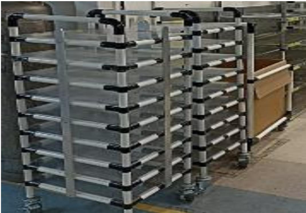
La acción de colocar dummy marcado con el número de parte en proceso es una de las actividades planteadas en las acciones la cual al estar de manera visible marca una pauta para reducir las mezclas en el área ya que, de manera visual, los operadores se podrán dar cuenta del tipo de material que se encuentra en su estación de trabajo.
