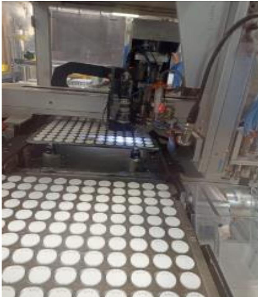
Nota: En esta imagen se puede ver que se la maquina cuenta con un sistema que permite sacar piezas malas del proceso mediante la inspección de cámara.
